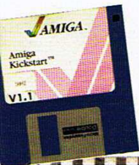
► Abajo: «Kickstart» venía en un disquete, pero con Amiga 500 fue un chip ROM de la placa base de Amiga.
